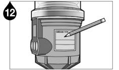
Anote la fecha de instalación así como la fecha de la finalización prevista del ciclo de lubricación en el lubricador utilizando la etiqueta proporcionada en el Service Pack para fines de mantenimiento.
